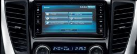
ENTERTAINMENT AND NAVIGATION ระบบเครื่องเล่นวิทยุ, DVD และระบบนำทางในรถยนต์ พร้อมระบบเชื่อมต่อ Bluetooth แบบ A2DP
