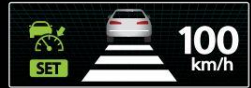
สัญลักษณ์แสดงการทำงานของระบบ ACC บนมาตรวัด
