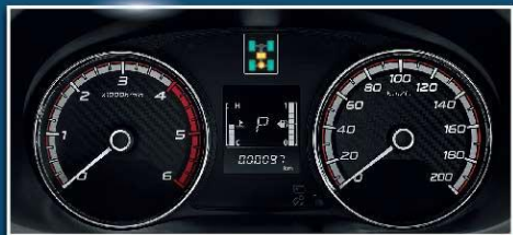
มาตรวัดรอบเครื่องยนต์ และความเร่งขนาดใหญ่ พร้อมของแต่งชุดเกียร์ชนิด (ระยะทางเกียร์ชนิด, อัตราการสิ้นเปลืองน้ำมันโดยเฉลี่ย, เครื่องปรับอากาศ, ระยะทางที่ลากรถชนิดที่) ได้จากปริมาณน้ำมันที่วิ่งอยู่ในถัง
