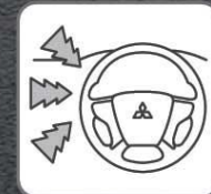
ระบบป้องกันการโจรกรรม จะอนุญาตให้ติดเครื่องยนต์ได้เฉพาะระบบกุญแจอัจฉริยะ ที่ส่งรหัสสัญญาณตรงกับระบบเท่านั้น ช่วยปกป้องความปลอดภัยจากการโจรกรรม
