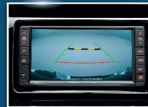
กล้องท้าย รุ่นที่ทุกมุมมอง ด้วยกล้องของหลังพร้อมเส้นการระยงบนจอ
