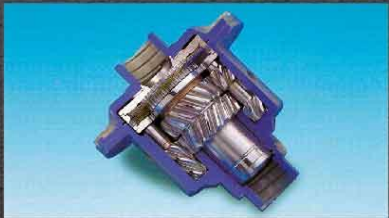
เฟืองท้ายลิimitslipแบบ LSD (Limited Slip Differential)
