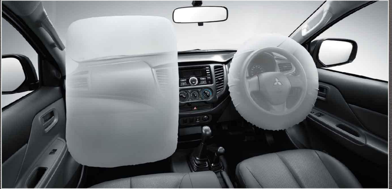
SRS AIRBAGS เสริมความปลอดภัยด้วยถุงลมนิรภัยคู่หน้า โดยทำงานร่วมกับระบบเข็มขัดนิรภัยแบบดึงกลับอัตโนมัติ ช่วยลดความรุนแรงที่เกิดจากการชนทางด้านหน้าของผู้นั่งขับขี่ และผู้โดยสาร
